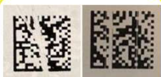
Нарушение целостности КМ*
